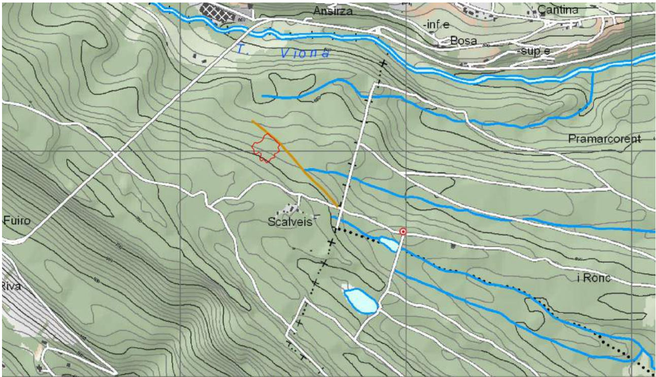
Figura 7: viabilità di accesso al lotto, in marrone la pista trattorabile, imposto camionabile in corrispondenza del cerchio rosso.
